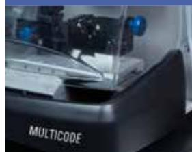
**La pantalla protectora y la bandeja para recoger virutas bloquean el funcionamiento de la máquina mientras están abiertas.**
